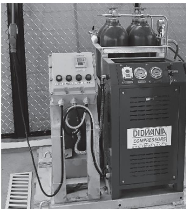
Compresor para la compresión y almacenamiento en balones del biometano obtenido.
