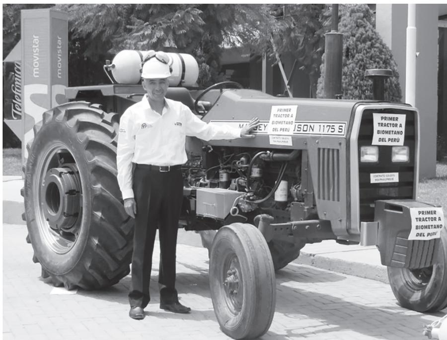
Luego el biometano fue presurizado y almacenado en balones de gas y utilizado para mover automóviles, tractores, motocultores, equipos de generación eléctrica, secadores, etc.
