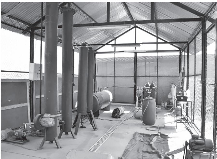
Sistema de Scrubber y PSA para la purificación del biogás.
